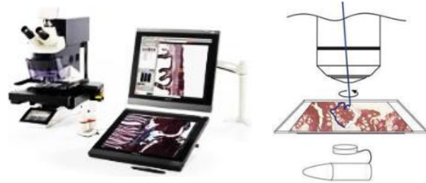
レーザーマイクロダイセクション(LMD) による組織片の回収
